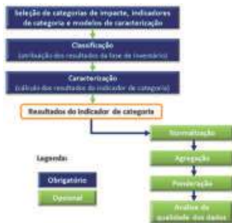
FIGURA 31. Elementos obrigatórios e opcionais da fase de avaliação de impacto ambiental, segundo as normas da série da ISO 14040
