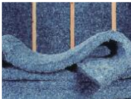
FIGURA 41: Manta em algodão reciclado.
