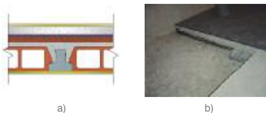
FIGURA 14: Isolamento na face superior de pavimentos, com revestimento cerâmico: a) desenho esquemático; b) situação real com aplicação de ICB.
