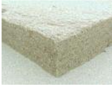
FIGURA 42: Manta em fibras de linho.
