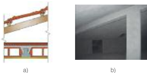
FIGURA 10: Cobertura inclinada com desvão e esteira em laje de betão: a) desenho esquemático; b) situação real.
