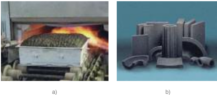
FIGURA 47: Vidro celular: a) processo de fabrico; b) produto final.
