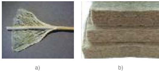
FIGURA 37: Cânhamo: a) fibras do caule de cânhamo; b) placas flexíveis de isolamento.
