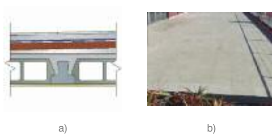
FIGURA 8: Cobertura horizontal revestida com material cerâmico: a) desenho esquemático; b) situação real.
