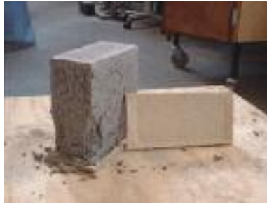
FIGURA 31: Bloco de betão constituído por agregados reciclados.
