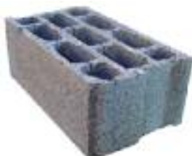
FIGURA 32: Bloco de betão com cortiça incorporada.
