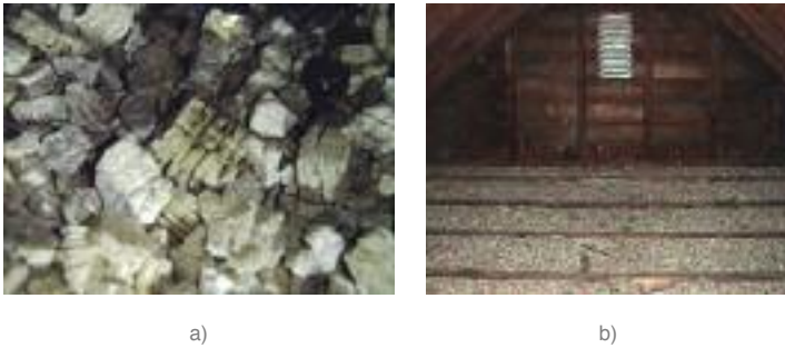
FIGURA 51: Vermiculite expandida: a) material a granel; b) aplicação no isolamento de um desvão de cobertura.
